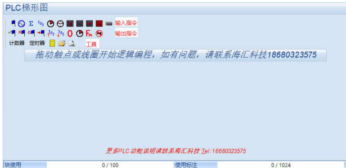
图 1 DSE7320MKII 内置 PLC 编程界面
